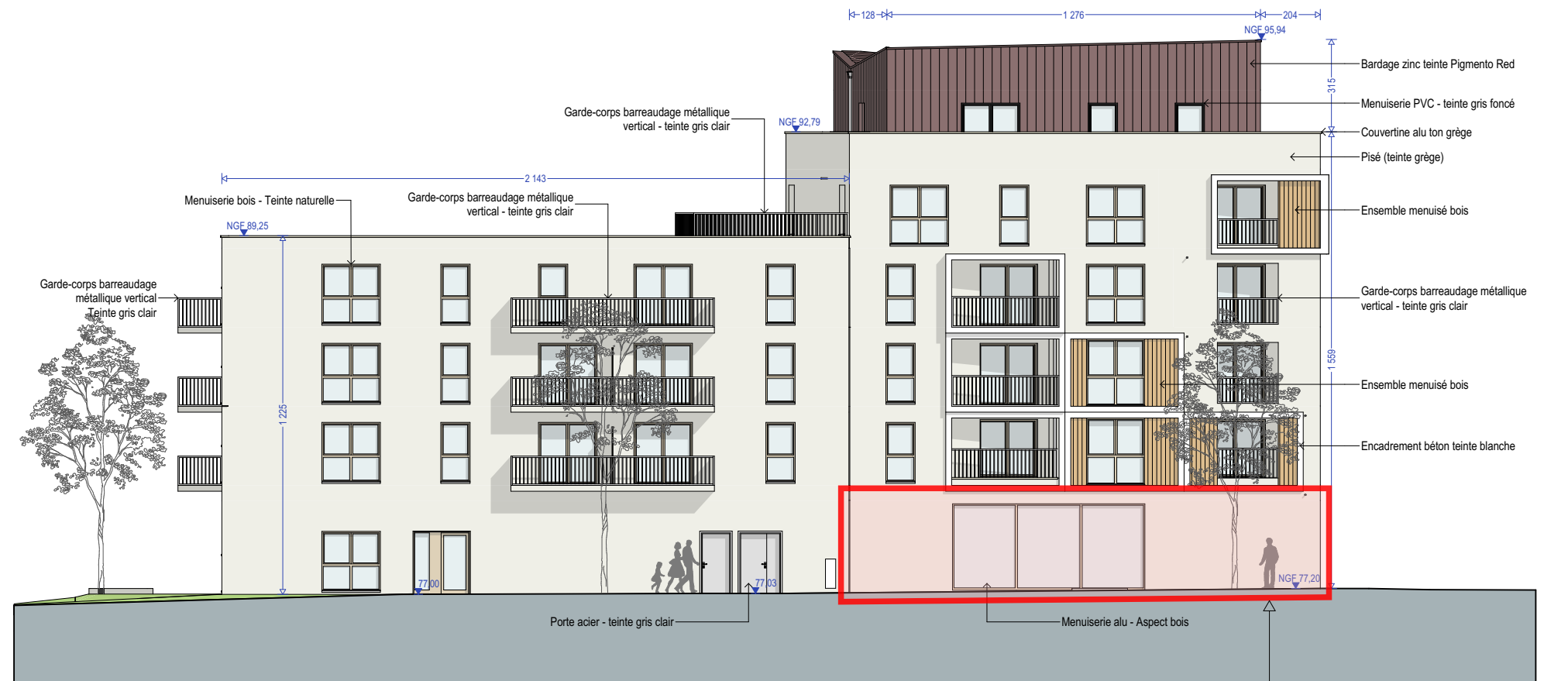
FA1-E - Façade Est
