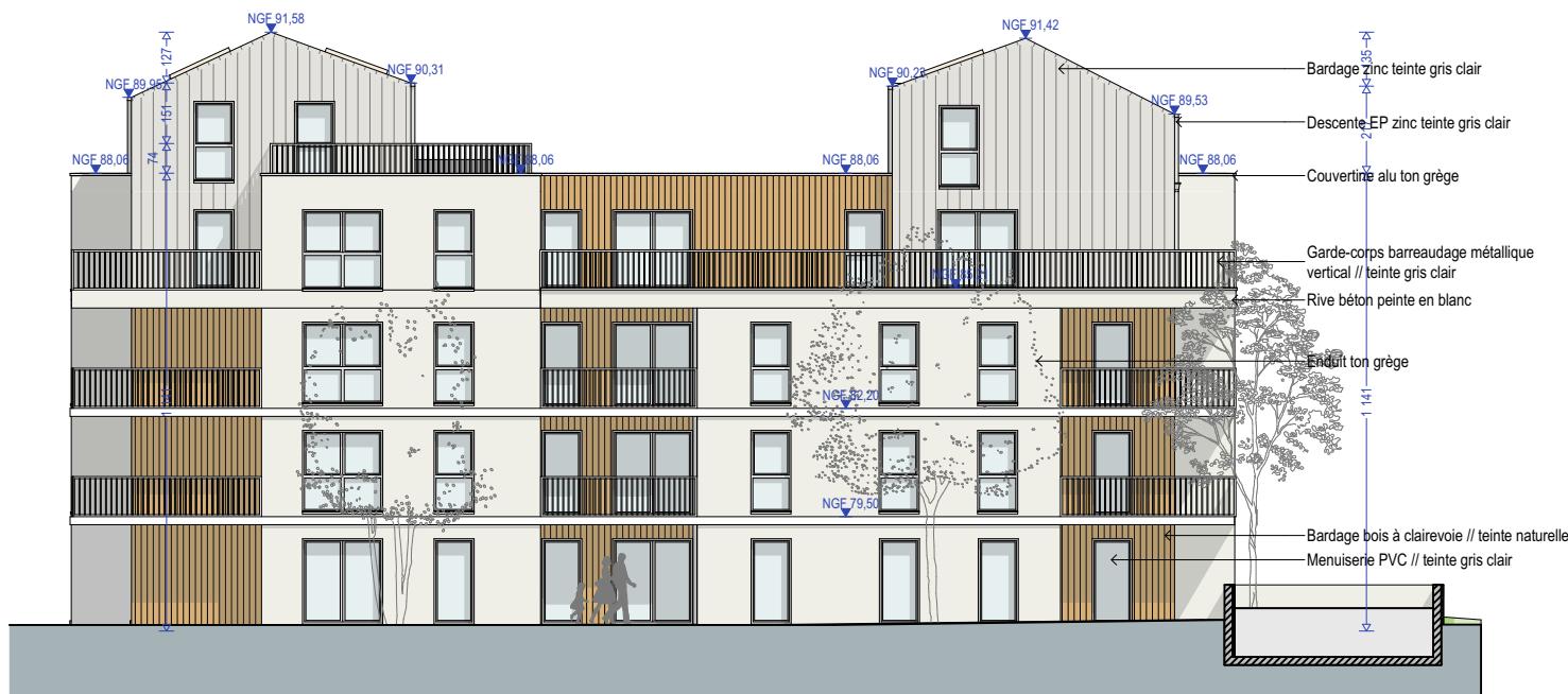
F1-O - Façade Ouest depuis rue
